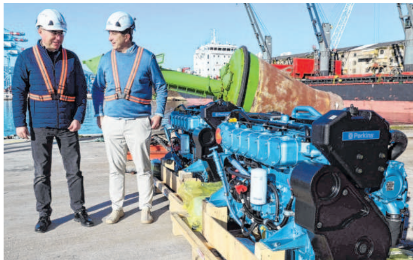
Dizelski motori, snage 200 konjskih snaga, namijenjeni su upravo za pogon radnih brodice
